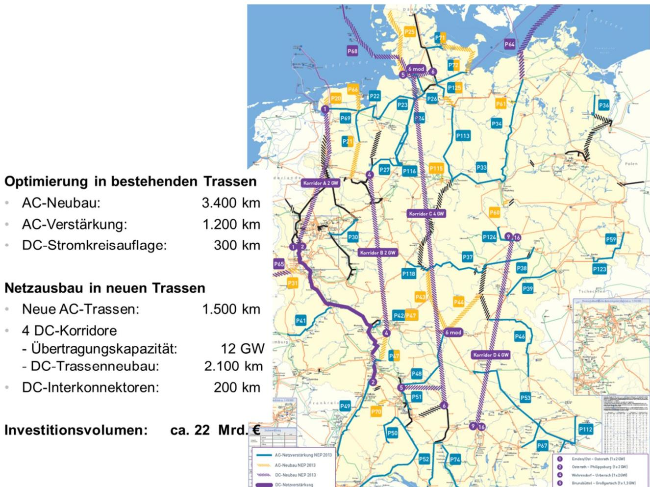
Abbildung 11: Netzverstärkungs- und Netzausbaubedarf für Gesamtdeutschland gemäß Leitszenario 2023 des Netzentwicklungsplans 2013
